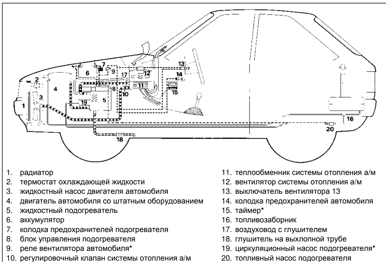
Рис. 3 Пример установки подогревателя (модификация с таймером) в легковом автомобиле
