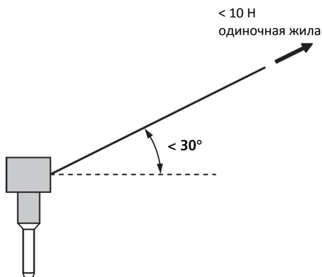
Рис. 9-5 Допустимый угол изгиба и допустимая нагрузка
