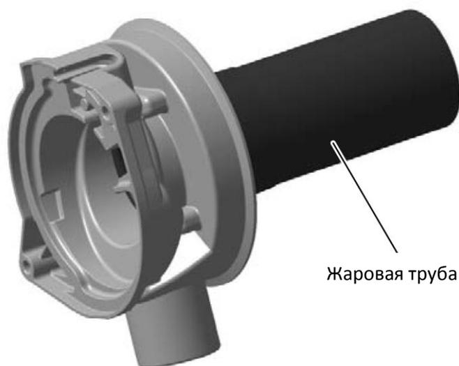
Рис. 2-5 Головная часть горелки с жаровой трубой
