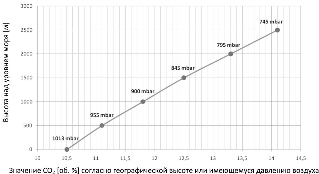
Рис. 6-1 Регулировка CO<sub>2</sub> (допустимо 10,5-14,1 об. %)
