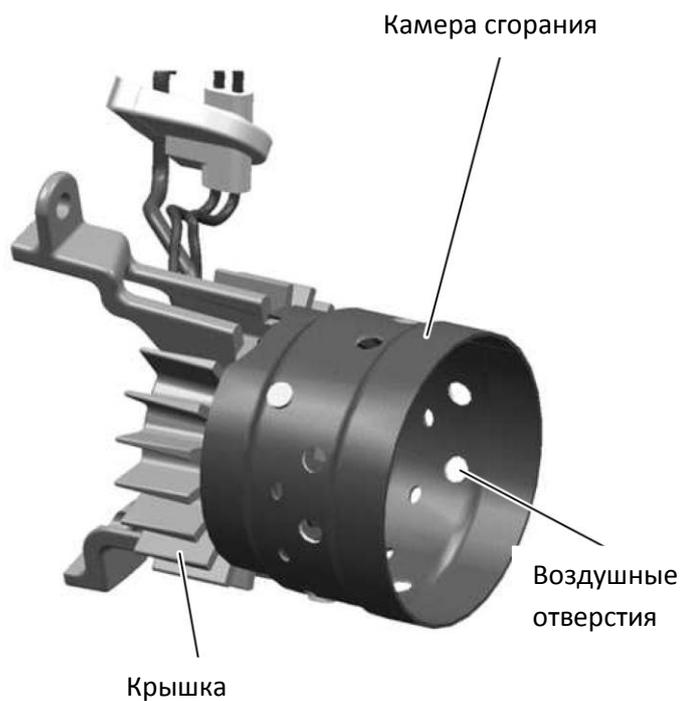
Рис. 5-5 Визуальный контроль, горелка в сборе
