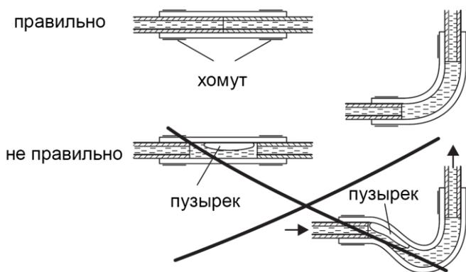
Рис. 807 Соединение трубки/шланги
