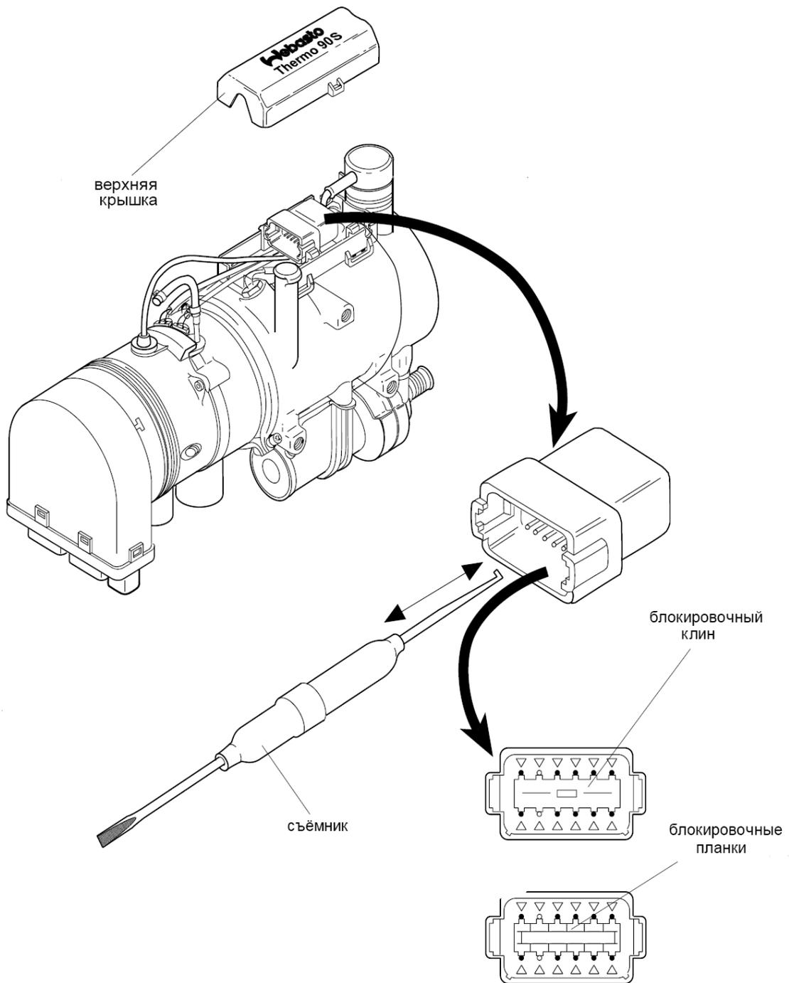
Рис. 901 Электрические соединения (Thermo 90 S)
