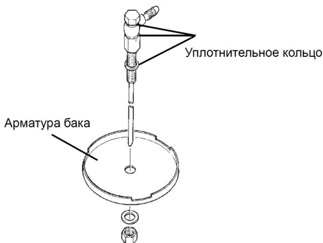
При установке в пластиковую арматуру бака, уплотнительное кольцо к арматуре бака должно быть резиновым.
